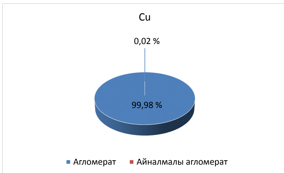
Сурет 3 – Қорғасынның (А) және мыстың (Б) агломерациялық күйдіру процесінен алынатын өнімдер арасында бөлініп таралуы
